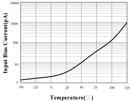
图 3 输入偏置电流与温度关系
