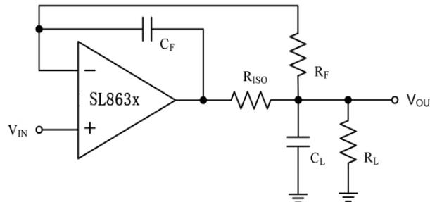
图 13 以直流精度间接驱动重容性负载
