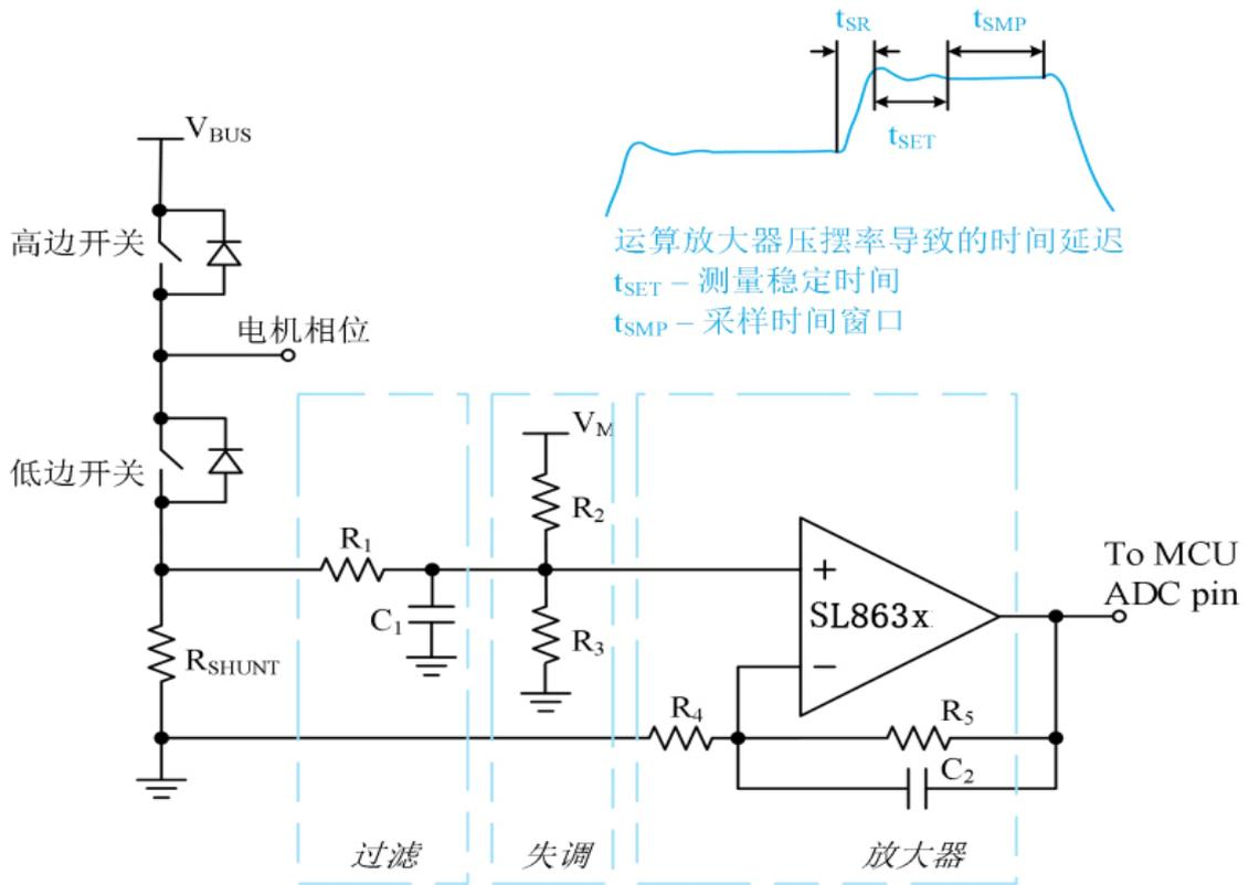
图 17 电流分流监控电路
