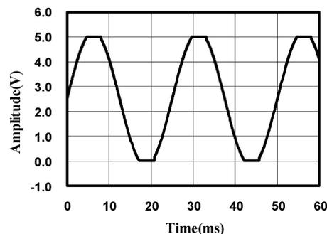
图 11 无相位翻转在输入超过电源电压时
